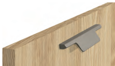
Maniglia K92 finitura grigio selce anta da L 15 a L 30 → passo 64 mm anta da L 40 a L 65 → passo 160 mm anta da L 75 a L 120 → passo 320 mm
