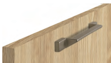
Maniglia K87 finitura nichel lux anta da L 15 a L 30 → passo 96 mm anta da L 40 a L 65 → passo 160 mm anta da L 75 a L 120 → passo 320 mm
